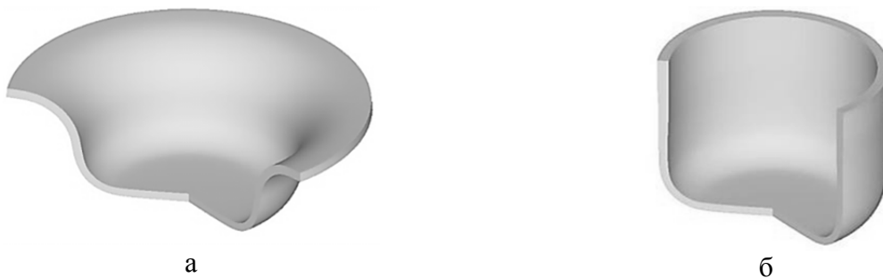
Рис. 2. Здеформовані заготовки в розрізі при максимальному зусиллі витягування (а) та в кінці витягування (б)
